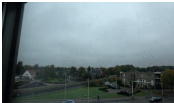
Op het glasoppervlak zijn veel zwarte stippen storend zichtbaar. Foto's: Peutz Geveltechniek
