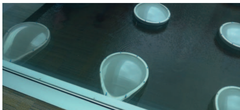
Figuur 5: Beeldvertekening bij de rand van een isolatieruit met een brandwerend binnenblad.
