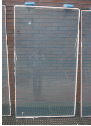
Zichtbare waas door veroudering bij gehard gelaagd glas met gel tussenlaag.
