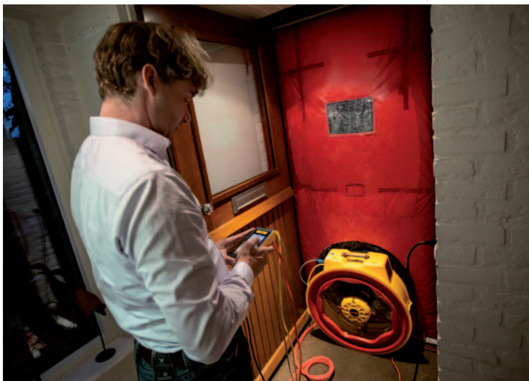
▲ Bij de luchtdoorlatendheidsmeting is gebruik gemaakt van een blowerdoor.
